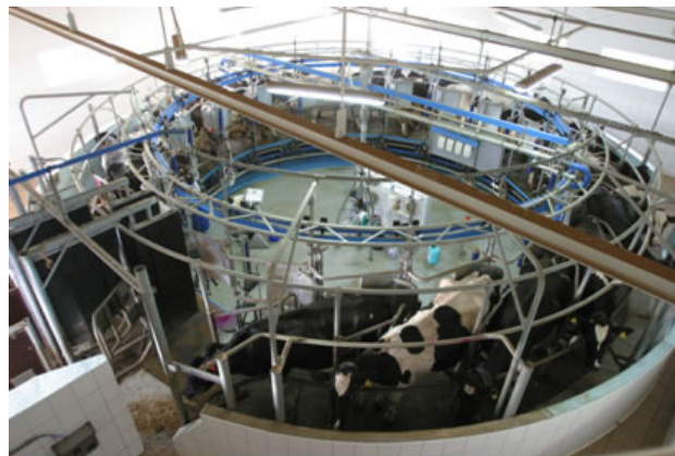
Figura 15 - Máquina de ordenha rotativa
